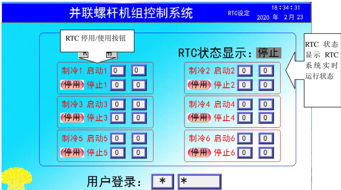
4.10.1 RTC 设定功能是根据时钟运行的功能 本页使用密码 1 进行操作，“RTC 停用/使用”按钮显示“RTC 停用”时,RTC 功能停用，系统按设定工况自动运行，全天 24 小时可开机，当显示“RTC 使用”是系统只能在 RTC 设定时间内按工况自动运行,设定时间以外停止运行。每天只能设定 6 组开机时间。
