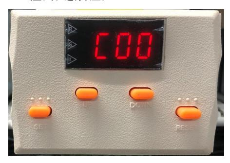
3. 长按 SET 键(设置) 3 秒钟, 屏幕数值变为默认值 5 后, 按 UP 键(向上)设置与电流互感器数据相匹配的数值。例:互感器型号为 500:5, 数值就要设为 500A。设置完毕后按 SET 键。C00(量程)设置完成。
