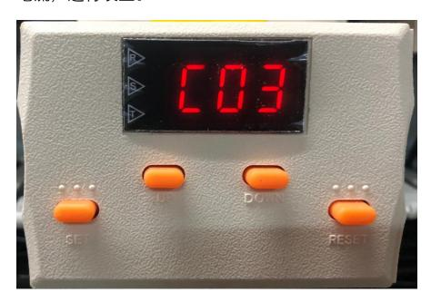
5. 按 UP 键或 DOWN 键把数值设置成电机的最大运行电流。长按 SET 键 10 秒保存设置。例:压缩机的最大运行电流为 234A,刚把数值调到 234,长按 SET 键 10 秒。C03(过电流)设置完毕。
